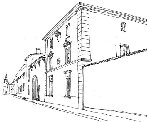
Ordonnancement des ouvertures, effets d'ornementations : chaînes d'angles, corniches, frontons classiques.
