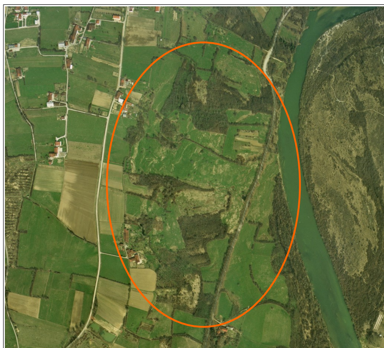
Figure III.25: vue aérienne de 1971 montrant le glissement de terrain du versant de la Grange.
