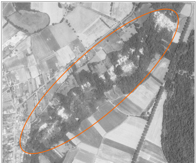
Figure III.78: traces de glissements de terrain sur le versant de Loyes visibles sur des photos aériennes de 1982.
