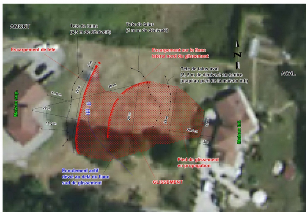
FIGURE 7 : PLAN SCHÉMATIQUE DU GLISSEMENT
